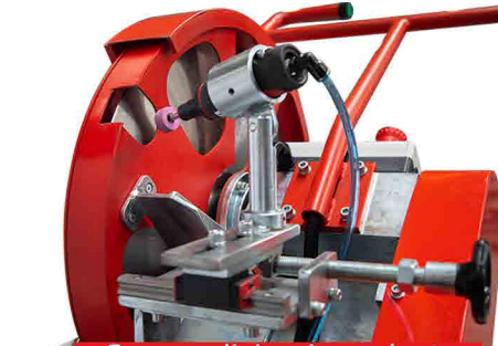
Ergonomik bıçak emniyet kapak mekanizması Bıçak Bileme Sistemi
